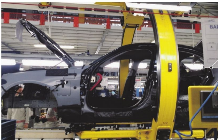
La linea di montaggio interna allo stabilimento dove si producono i due modelli Alfa, Giulia e Stelvio, e la Maserati Grecale
